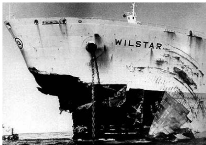
Рис. 119. Разрушение носовой части норвежского танкера «Уильстар» (Wilstar) в 1974 г. в результате действия волны с крутым фронтом.
