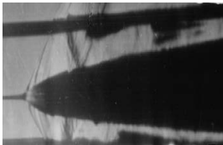
Рис. 174. Скоростная регистрация кавитационных процессов, возникающих при осесимметричном взрыве внутри заполненной водой цилиндрической трубки [68].
