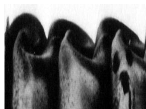
Рис. 209. Столообразные (слева) и грибовидные (справа) формы сжимаемого тонкого стержня, ограниченного сверху [14].
