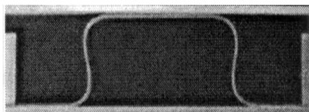
Рис. 209. Столообразные (слева) и грибовидные (справа) формы сжимаемого тонкого стержня, ограниченного сверху [14].
