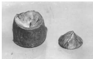
Рис. 80. Составляющие пробки, выбитой цилиндрическим ударником, пробивающим сплошной слой металла, и примеры оплавленных конических поверхностей Маха. Пробка (цилиндрический элемент материала слоя) распадается на цилиндр с конической выемкой (слева) и конический элемент, извлеченный из выемки (справа). Цилиндрические и конические поверхности оплавляются из-за пластических сдвиговых деформаций [122, 123].
