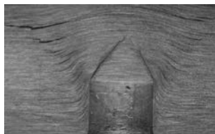
Рис. 77. Примеры конуса Маха в твердой среде и формирования перед ним трещин [122, 123].
