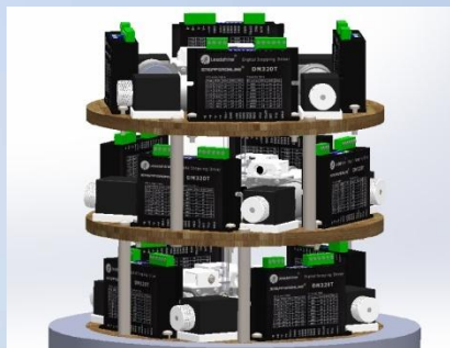
Компоновка силового модуля манипулятора
